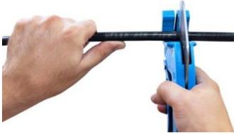
2. Después de cortar el tramo deseado, se acomoda en el sitio de instalación. En caso de necesitar hacer un doblar utilice el doblatubos UFLEX ACR para obtener la forma deseada.<sup>2</sup>
