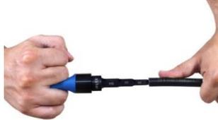
5. Atornille el cuerpo del conector en la válvula de servicio del evaporador o condensador del sistema de aire acondicionado.
