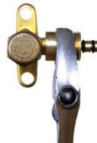
7. Empuje la tubería en el hombro de la conexión. Tenga cuidado de no dañar los O-ring.
