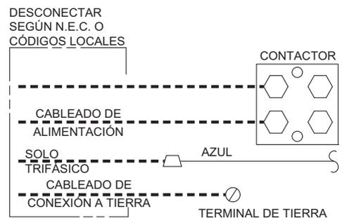
Fig. 6 – Fig. 6: Conexiones de la línea
