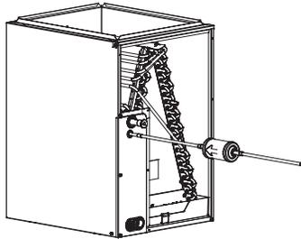
Fig. 3 – Filtro secador de la tubería de líquidos A05178
