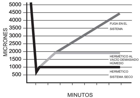
Fig. 4 – Fig. 4: Gráfico de vacío profundo A95424
