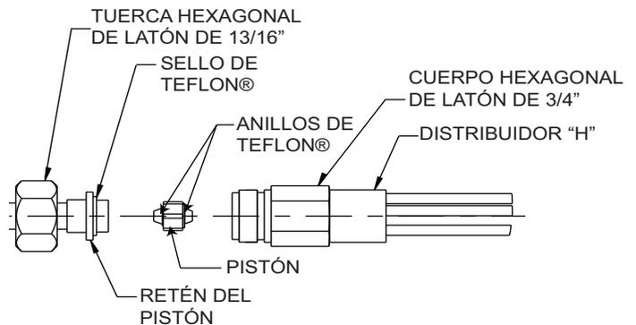
Fig. 5 – Fig. 5: Pistón para interiores (enfriamiento) A10342
