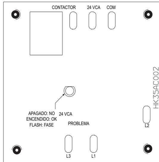
**Fig. 7 – Control de monitor trifásico**
