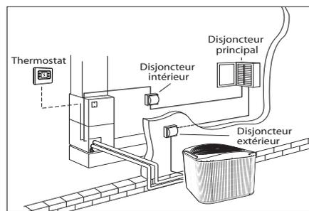
Fig. 1 – Disjoncteurs électriques
